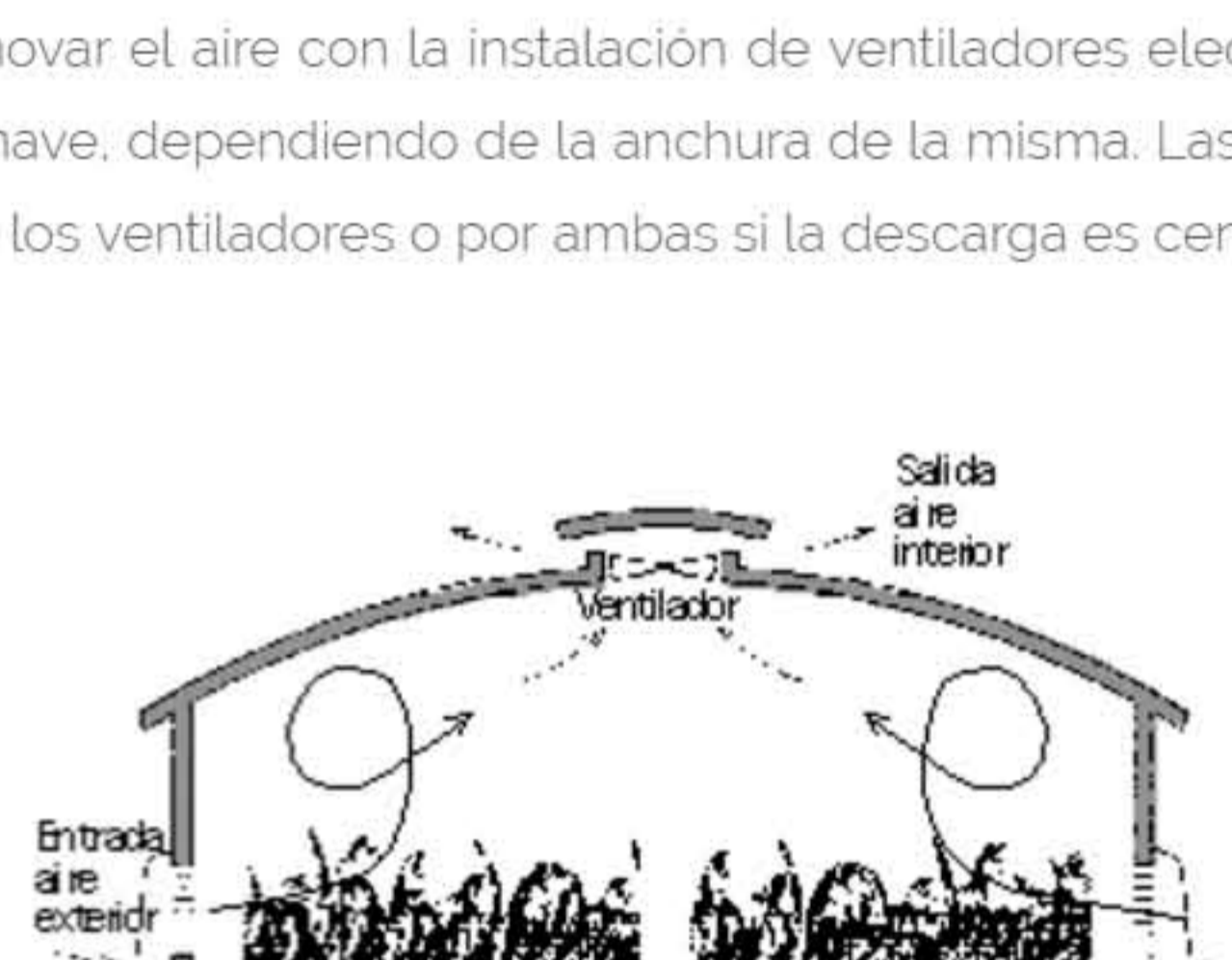
Fig. 4: Ventilación Mecánica Simple (Naves anchas)
