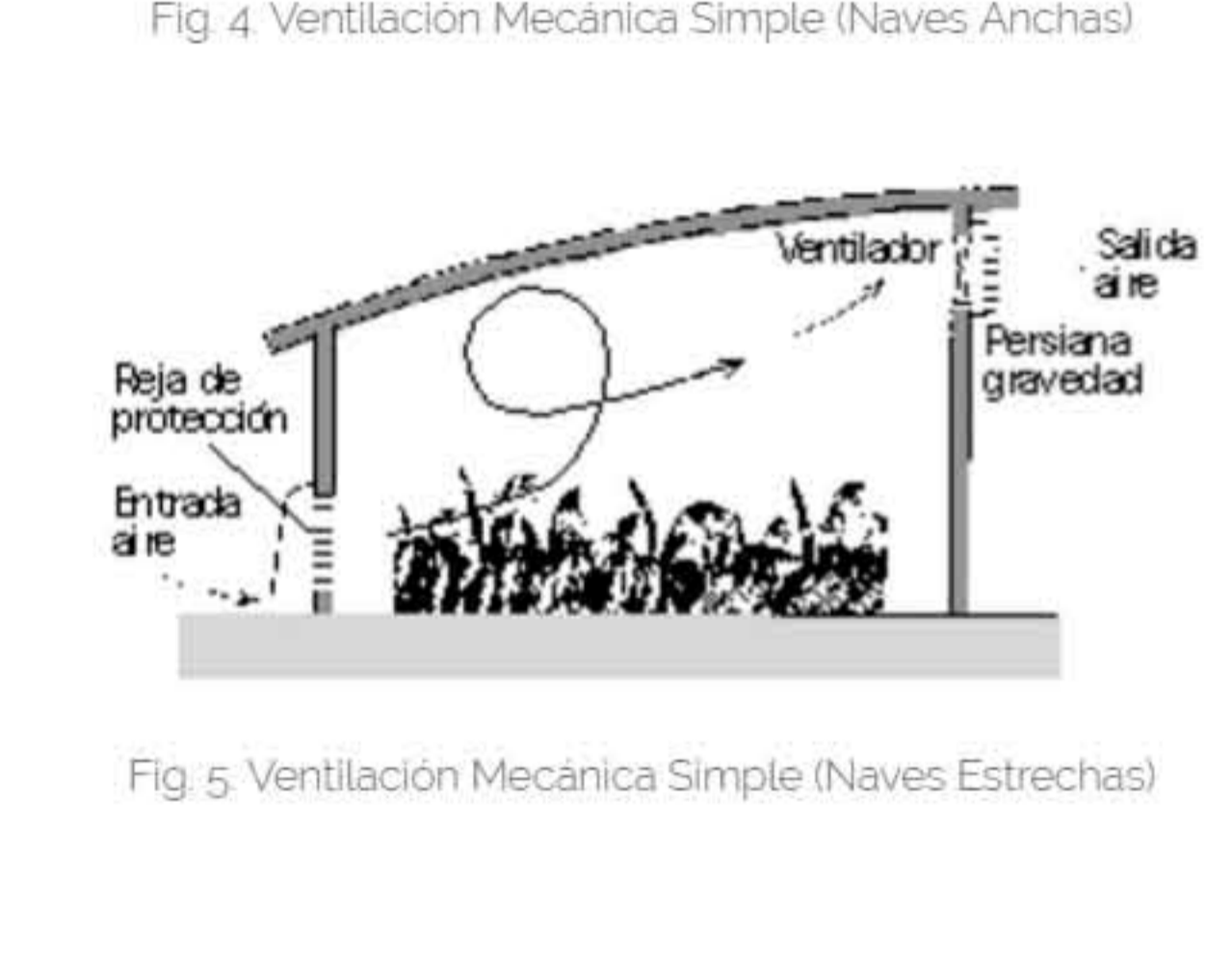
Fig. 5: Ventilación Mecánica Simple (Naves estrechas)
