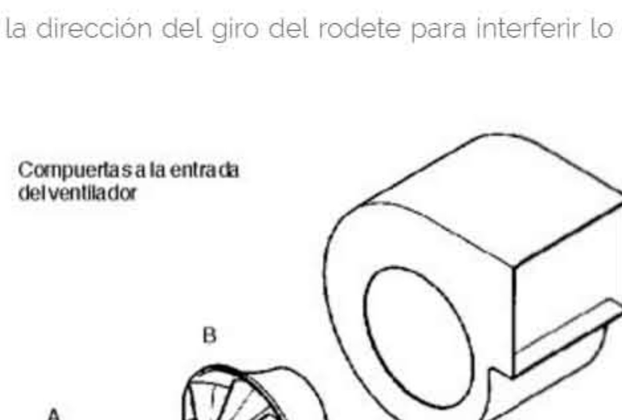
Fig. 6. Compuerta a la entrada del ventilador
