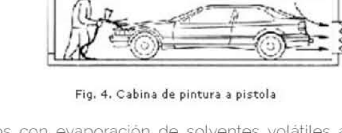
Fig. 4. Cabina de pintura a pistola
